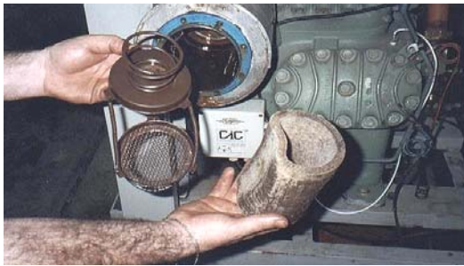
Foto 1 Filtro de sucção tipo feltro “deformado”, não fizeram sua troca no tempo certo, impurezas da instalação passaram pela carcaça e se misturaram com o óleo do cárter.
